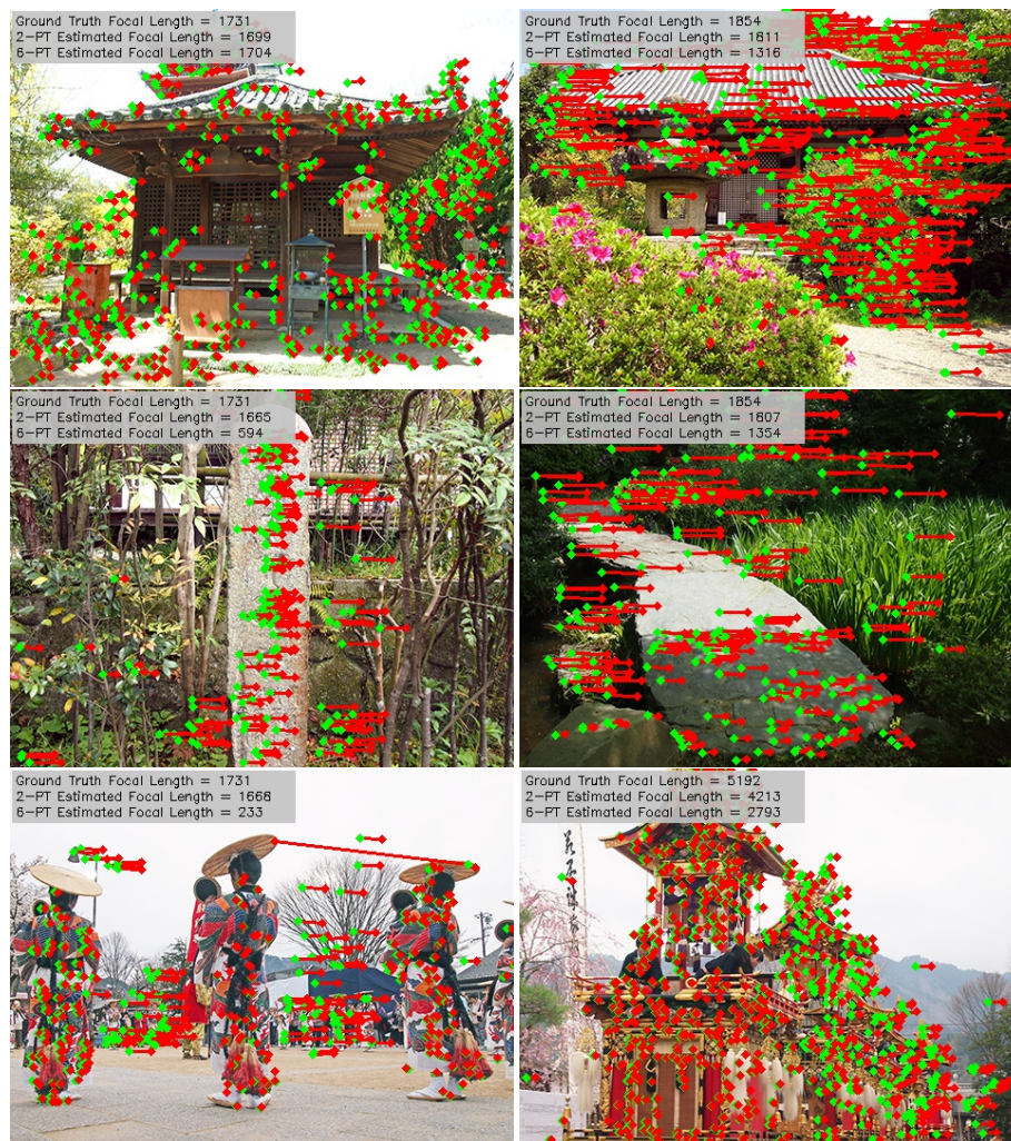
4. ábra: A tesztelő képpárok első képei. Zöld és piros pontok: pozíciók az első és a második képen. Vörös vonal: elmozdulás. A helyes fókusztávolságok, a 6-pontos algoritmus [13] eredménye és a javasolt módszer becslése a szürke háromszögön belül olvasható.
