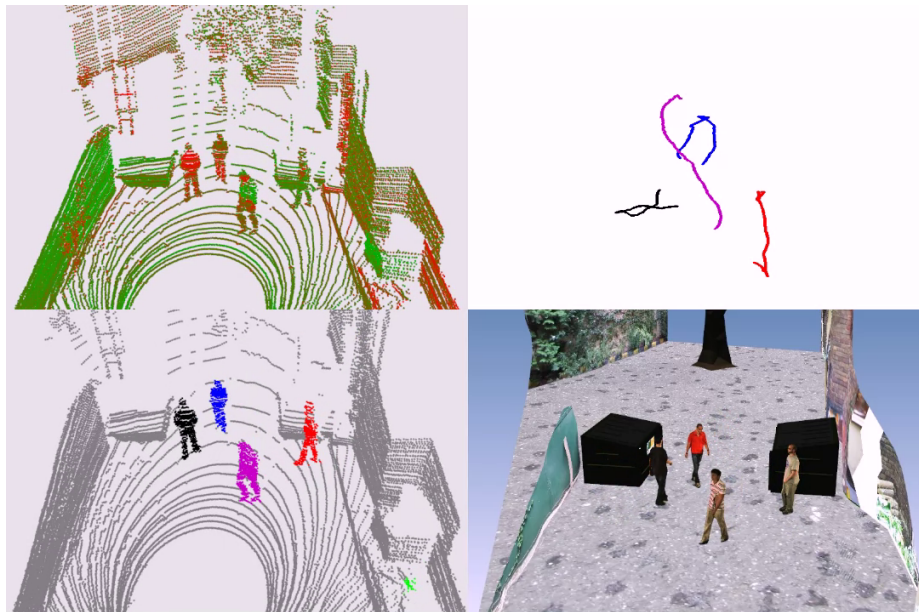
7. ábra: Objektum követés és rekonstrukció eredmények. Bal felül: nyers pontfelhő; bal alul: szegmentált és elkülönített objektumok; jobb felül: trajektóriák felülnézetből; jobb alul: rekonstruált környezet, a stúdióobjektumok elhelyezése a valós alakzat pozíciókba.
