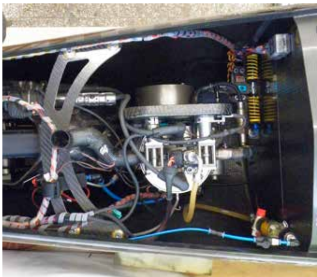
5.2. ábra: a motortér felülről: jobbra főt a kormány servo, lent a benzintartály
