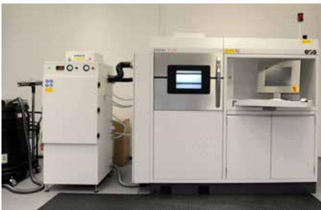
5. ábra: A Széchenyi István Egyetem Anyagtudományi és Technológiai Tanszékén üzemelő lézerszintező berendezés
