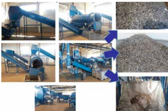
14. ábra: a fehérvárcsurgói szeparációs prototípus és az általa leválasztott anyagfrakciók
