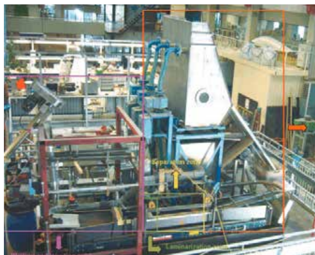
12. ábra: a W2Plastics projekt keretében a Delfti Műszaki Egyetemen felállított magnetohidrosztatikus szeparátor
