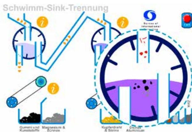
10. ábra: fajsúlykülönbségen alapuló szétválasztó berendezés flotálóelvi vázlat
