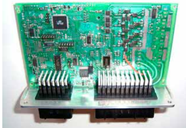
6.2. ábra: a VEMS motorvezérlő ECU, 2011
