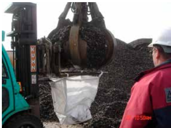
13. ábra: shredderkönnyűfrakció mintavételezése
