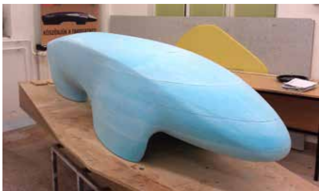
3.3. ábra: a polisztirolmag marással készült
