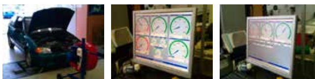
10. ábra: jármű a görgős padon, mérés közben
