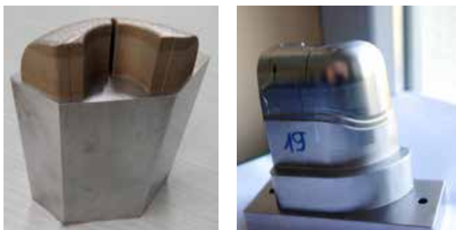
8 – 9. ábra: előgyártmányra szinterezett szerszámbetét (hybrid mold), megmunkálás előtt és után
