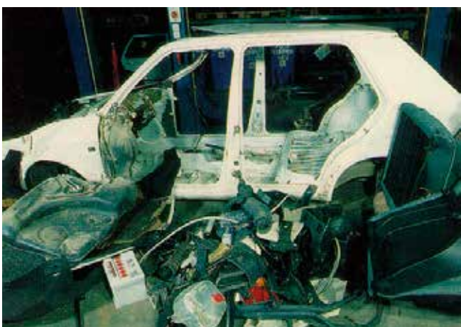
11. ábra: nagyobb alkatrészeitől előbontott nyers karosszéria
