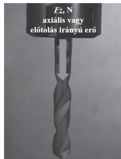
2. ábra. Ø 10 mm fúró CFRP anyagokhoz (DreamDrills – DI473100)
