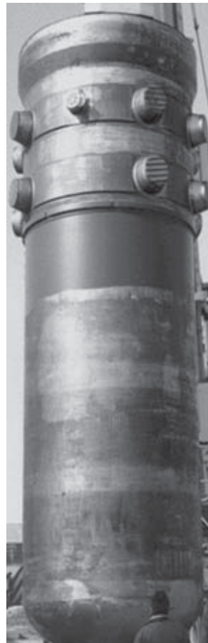
2. ábra: Egy VVER-440/V-213Cs reaktortartály metszete a fő méretekkel (bal) és a tartály fényképe
