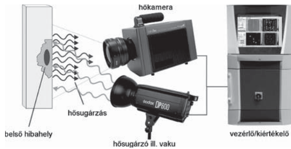
2. ábra: a rávilágításos eljárás elrendezése
