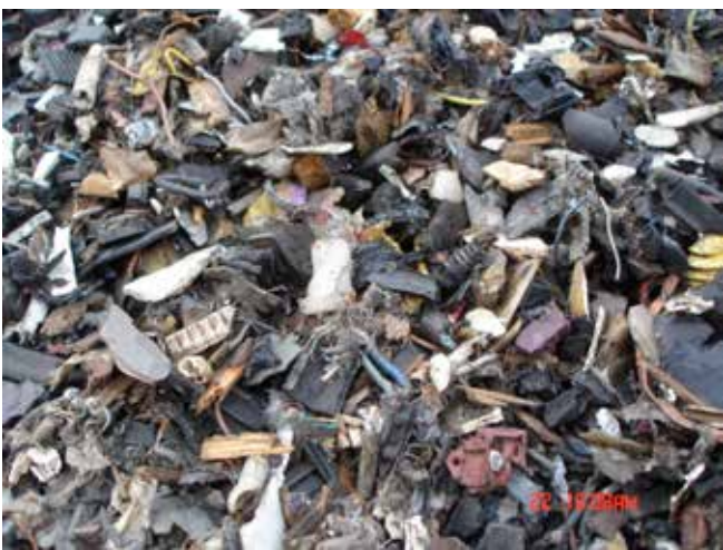
7. ábra: shredder-könnyűfrakció, vegyes műanyag, gumi-, textil- és üvegrakció
