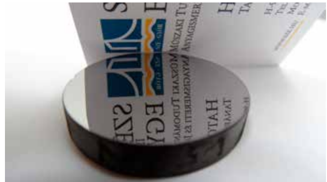
6. ábra: lézerszinterezett szerszámacél felülete polírozás után
