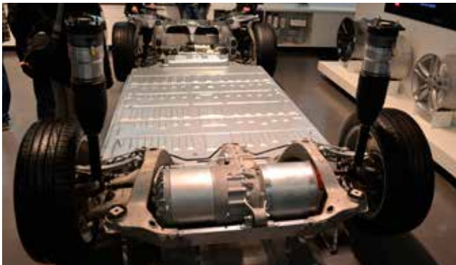
6. ábra: tisztán elektromos személygépkocsi alváza (Fénykép: Oleg Alexandrov)
