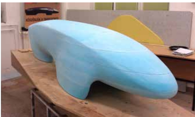
3.3. ábra: a polisztirolmag marással készült
