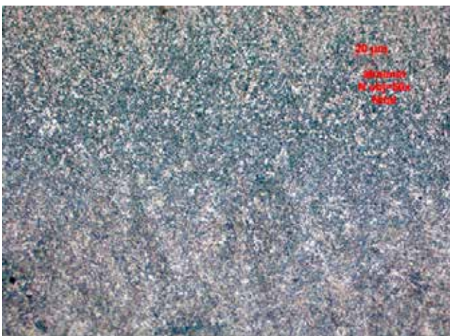
4. ábra: ES edzett kéreg és átmeneti zóna
