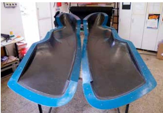
3.4. ábra: a szerszám üvegszövetből készült (kék), benne a test
